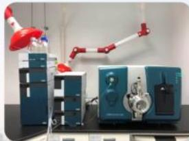
AB SCIEX-液相色谱串联质谱检测系统
